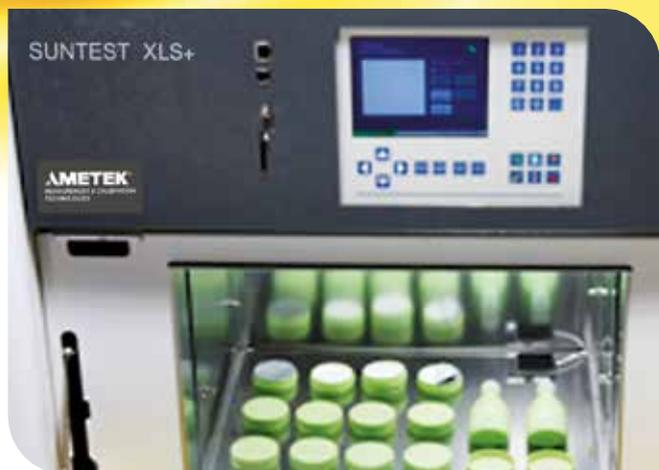
平板式测试技术可以用于测试各种形状与尺寸的试样。用于降低试样温度的可选配件对于热敏产品(如药品或化妆品)的光稳定性测试是非常有用的工具。
